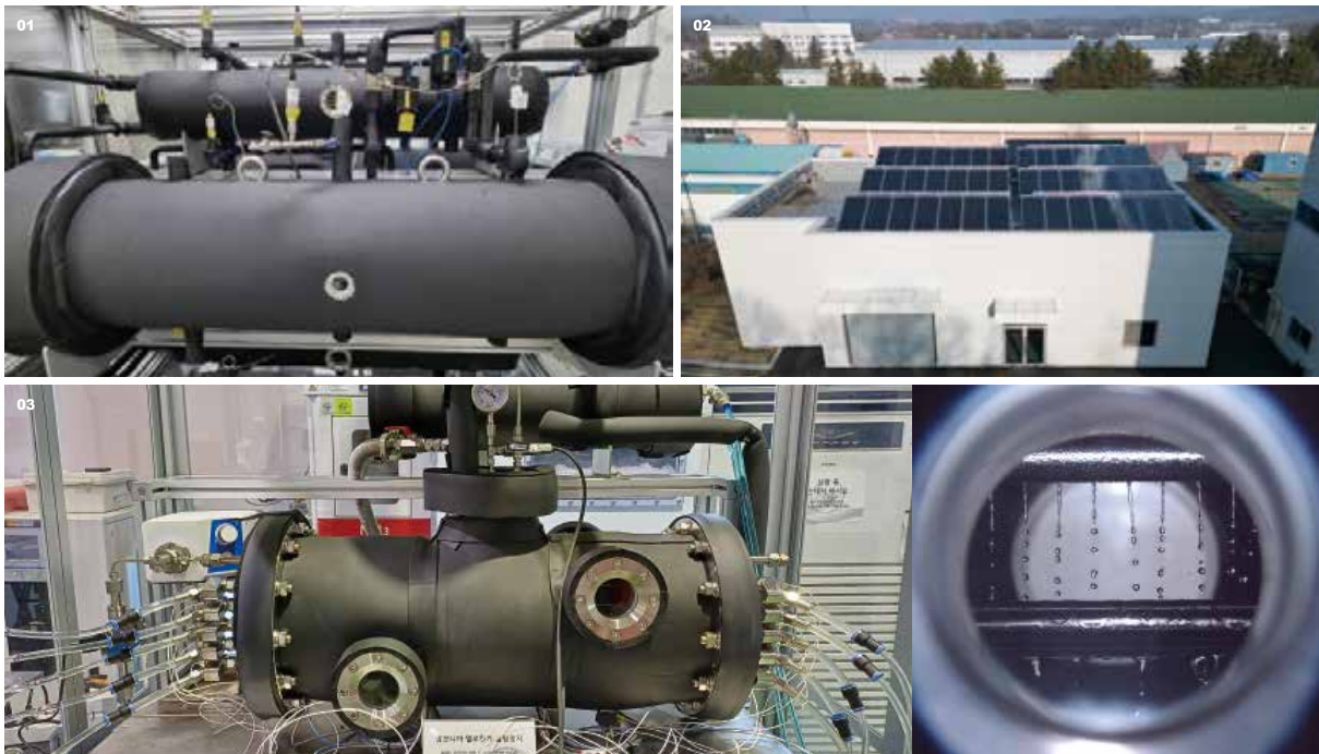
Fig. 01 1kW급 화학흡착식 히트펌프 시스템
