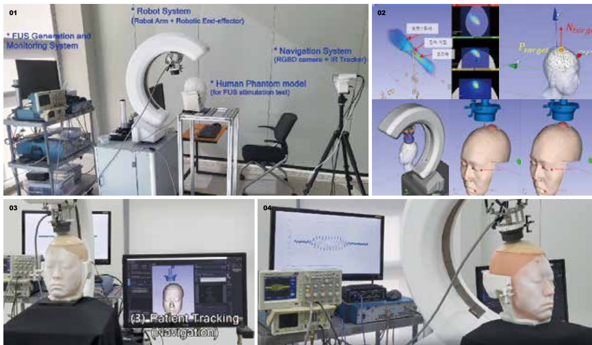
Fig. 01 전체 시스템 사진 Fig. 02 영상유도 내비게이션 Fig. 03 영상-환자 정합 Fig. 04 초음파 집속 구현
