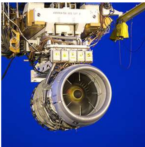
<그림 3> GE와 Snecma의 합작회사 CFM이 개발한 LEAP 제트 엔진 9)
