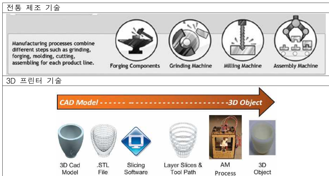
<그림 1> 기존 전통 제조 기술과 3D 프린팅 기술과의 비교 2)
